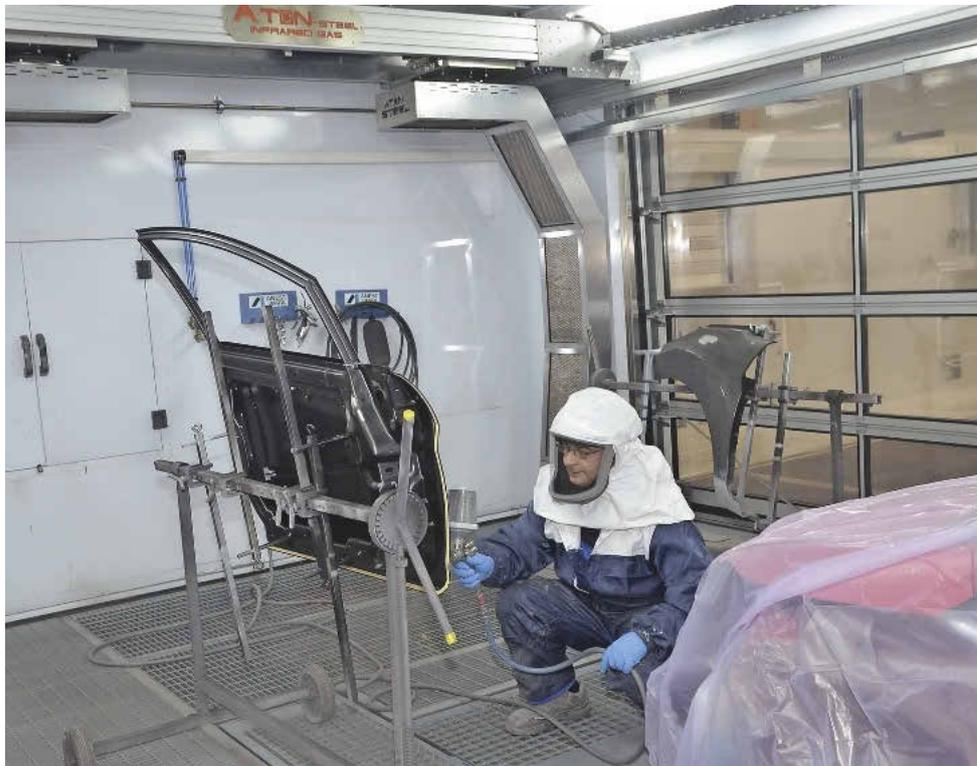
Die Kabine ist mit einem gasbetrieblenen Trocknungsbogen ausgestattet, bietet aber auch die Möglichkeit, konvektiv zu trocknen.
